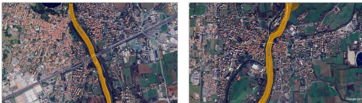
Figura 45. Dettaglio dell'involuppo delle aree a rischio diga (scarico rapido e collasso, in arancio) per il territorio dei due comuni di Trezzo sull'Adda (a sinistra) e Vaprio d'Adda (a destra). La linea bianca indica i limiti comunali.
