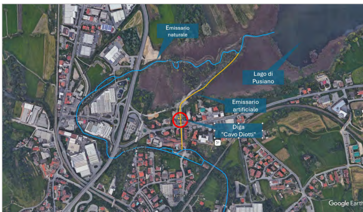
Figura 46. Schema del nodo idraulico del Cavo Diotti. In azzurro il corso naturale del Lambro. In arancio il tratto artificiale regolato dalla Diga.
