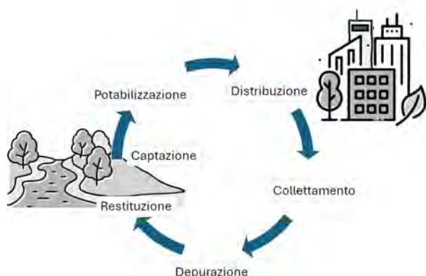
Figura 93. Rappresentazione schematica del ciclo del Servizio idrico integrato
