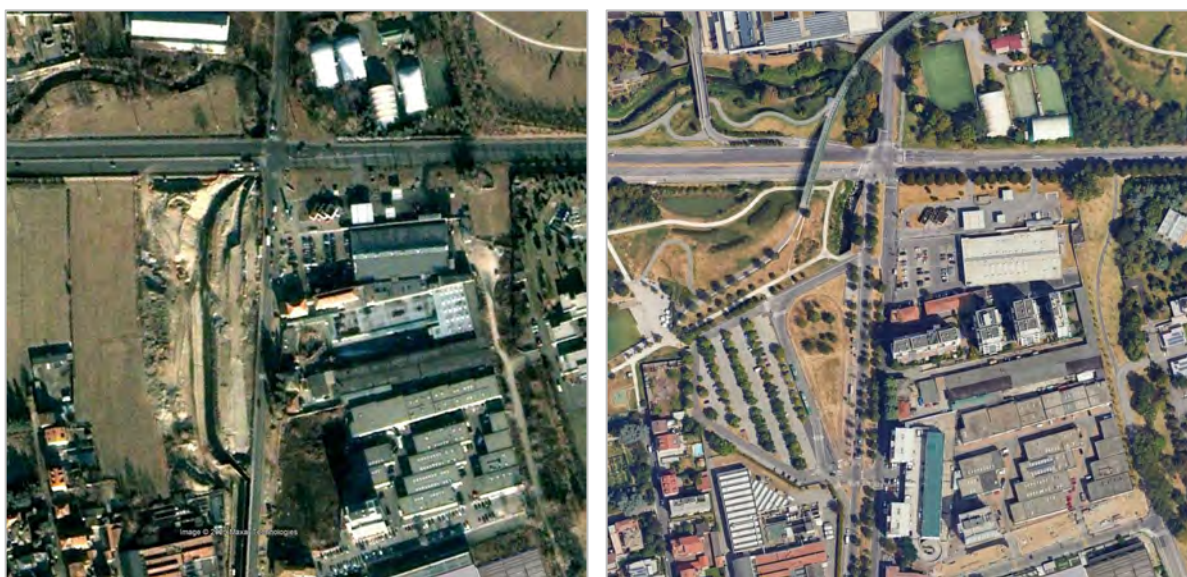
Figura 23. Seveso a Via Ornato. A sinistra, aerofoto del 10 gennaio 2002. Si notano i lavori per la realizzazione del tombino con la creazione del bypass necessario alla sicurezza del cantiere. A destra la stessa area nell'assetto attuale con il corso tombinato tutta la lunghezza della strada. Si notano (immagini Google).
