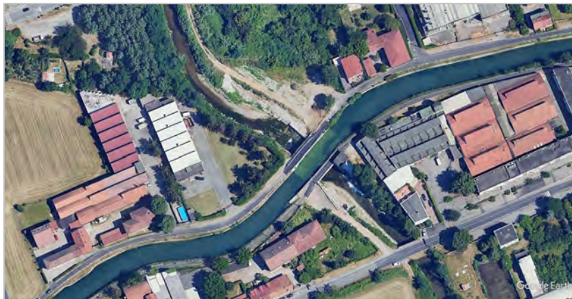
Figura 64. Il ponte-canale con il quale il Canale Villoresi sovrappassa il Molgora a Pessano con Bornago e la adiacente passerella pedonale. Ambedue le opere sono tra quelle (numerose) critiche per il passaggio delle portate di piena.
