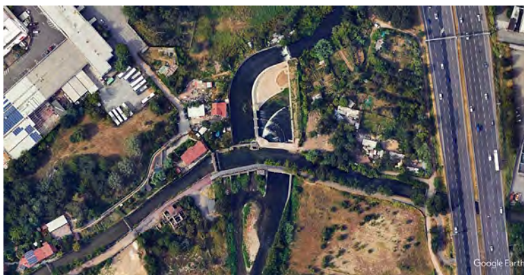
Figura 43. Il nodo idraulico di Cascina Gobba dove il Lambro (direzione Nord-Sud) sottopassa il Naviglio Martesana (direzione Est-Ovest). Immagine Google Earth.
