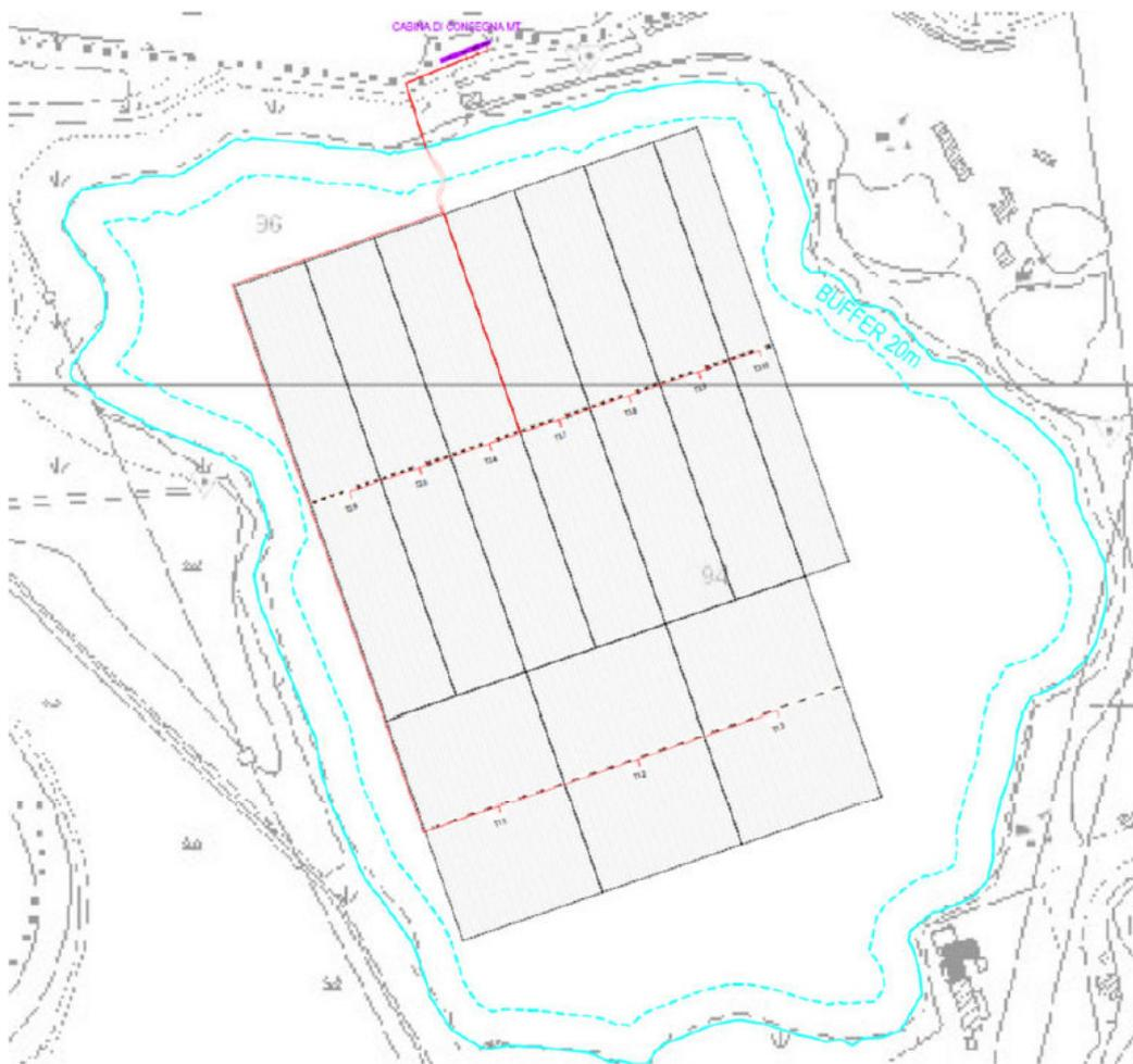
La linea elettrica di trasmissione dell'energia generata tra i campi FV e l'esistente Cabina Primaria di Peschiera Borromeo sarà costituita da un elettrodotto interrato esercito in Media Tensione. Il percorso del sovra-menzionato elettrodotto in MT si sviluppa per una lunghezza complessiva pari a circa 2,2 km, ed è stato studiato al fine di adeguarne il percorso a quello delle sedi stradali pre-esistenti, evitando ove possibile gli attraversamenti di terreni agricoli.
