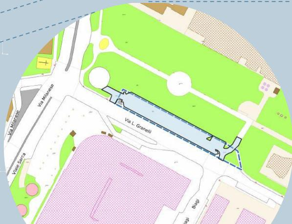
Riqualificazione del parcheggio Granelli con parziale depavimentazione per creare nuove zone verdi e alleggerimento della rete fognaria mediante sistemi di ritenzione sotto la superficie stradale.
