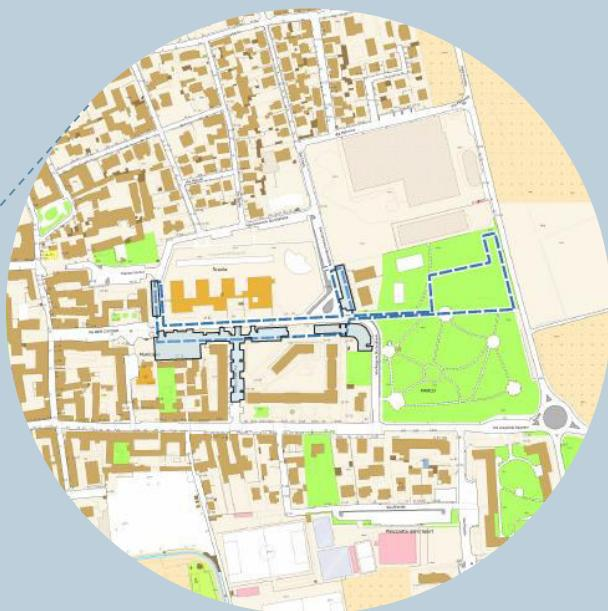
Valorizzazione di un'area degradata del parco attrezzato di via Rogerio da Sedriano, mediante depavimentazione di un'area e rifunzionalizzazione di un laghetto come sistema di laminazione e bioritenzione delle acque drenate dalle superfici a parcheggio e stradali di via Rogerio stessa.
