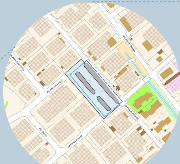
Disconnessione della rete di piazza Allende mediante realizzazione di box alberati, trincee drenanti e pozzi di infiltrazione
