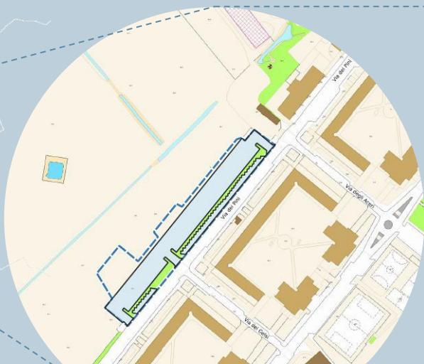
Nuovo sistema di drenaggio della strada e del parcheggio di via dei Pini basato su trincee drenanti e pozzi di infiltrazione e disconnessione dalla rete fognaria.
