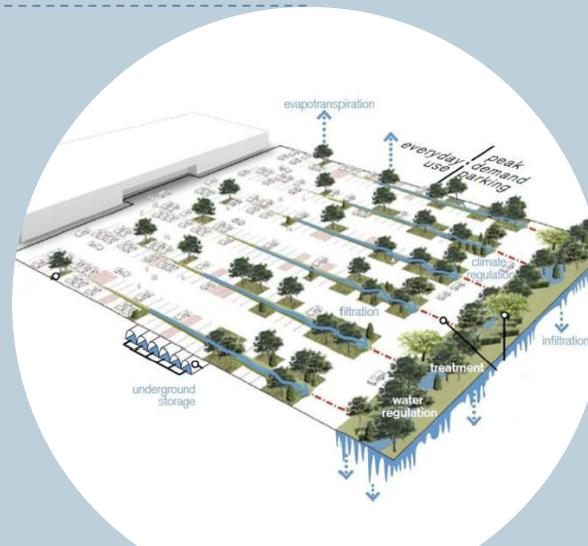
Disconnessione della rete di via Como-via Venezia e del parcheggio attiguo mediante realizzazione di aree di bioritenzione e pozzi di infiltrazione
