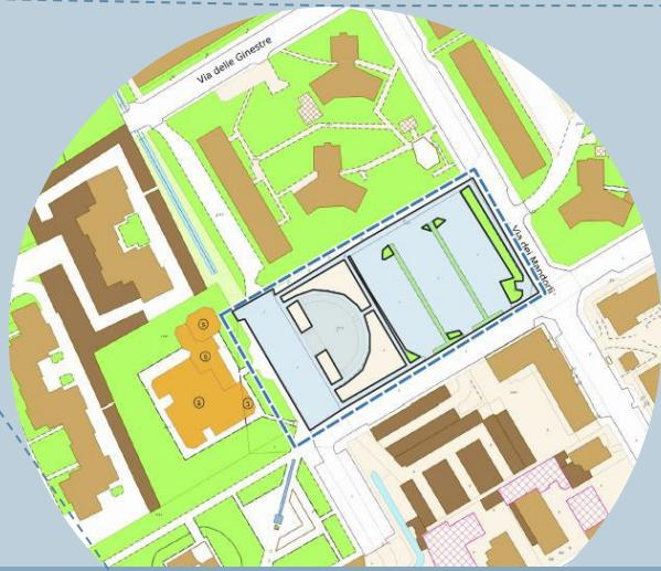
Disconnessione della rete di un parcheggio in via delle Acacie, mediante aree di bioritenzione e bacini di detenzione
