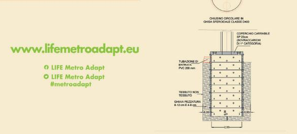
▲ Particolare costruttivo di un pozzo perdente. Detailed view of a percolation shaft.
