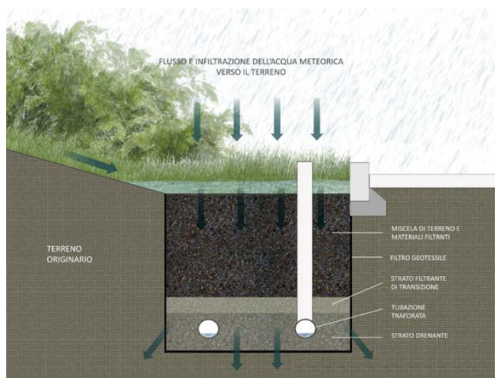
Figura 35. Sinistra: esempio area di bioritenzione. Ballard et al., 2015 Destra: Tipologico area di bioritenzione. Comune di Bologna, 2018
