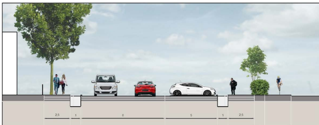
Figura 33. Stato di progetto – Alternativa 2.1. Planimetria e sezione di un tratto di Via Lombardia, Città di Parabiago
